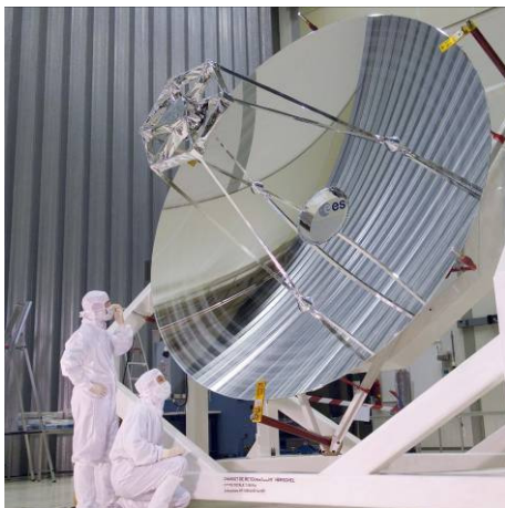
Spiegelsegmente bei der Vormontage und fertiger Spiegel bei der optischen Kontrolle.
