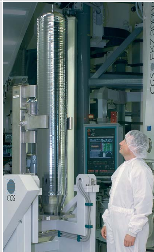
300 mm-Kristall aus einer Charge von 350 kg Silizium (produziert in einer EKZ 3000/450 von CGS, mit freundlicher Genehmigung der Siltronic AG, Burghausen)
